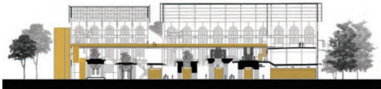
Il. 16. Przekrój przez zachowany budynek elektrowni Silahatarağa w Stambule, z wbudowanym pomostem dla zwiedzających i widocznymi urządzeniami w muzeum Energii [35]
