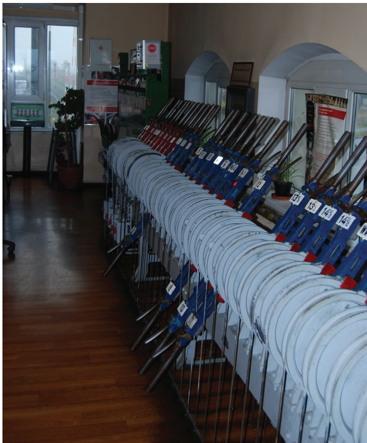
Il. 4. Nastawnica mechaniczna firmy Hein Lehmann & Co z 1905 r. (Wolsztyn). Stan w 2019 r. (fot. P. Mierosławski)
