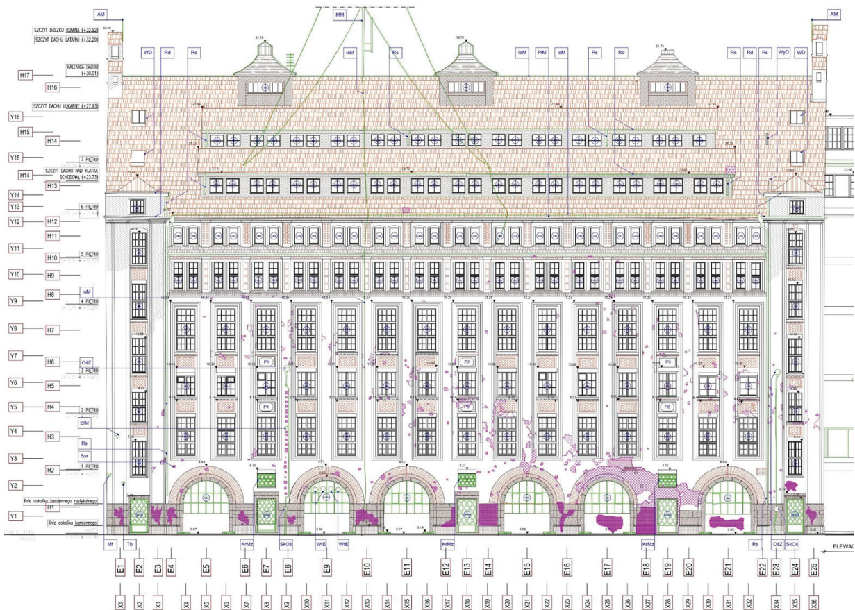
Il. 10. Analiza konserwatorska stanu zachowania elewacji południowej budynku frontowego piekarni „Mamut” przy ul. Sienkiewicza 18–22 we Wrocławiu (pierwotnie magazyn mąki). Stan fasady w lipcu 2018 r.
