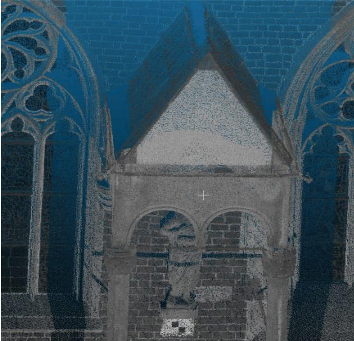
Il. 5. Fragment skanu z widocznymi brakami oraz rozrzedzoną chmurą punktów (oprac. P. Szymański)
