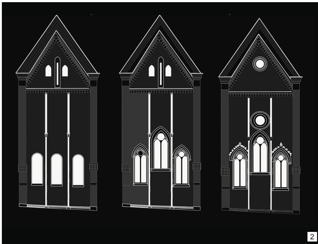
Il. 6. Kraków-Mogiła, elewacja wschodnia kościoła opackiego: 1 – stan z 2017 r., 2 – projekty mapowania widoków w kolejnych fazach budowy (oprac. E. Łużyniecka)
