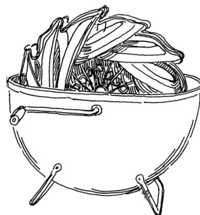
Rys. 221. Urządzenie do mycia talerzy zawieszonych na obrotowych uchwytych poruszanych korbą. Rys. autora na podst.: [Haselsteiner 2000: 28]
