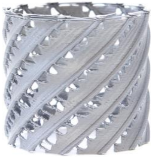
Fig. 11. 12 ribs with 60°, V_{rib} : 400 mm/min, V_{cyl} : 1600 mm/min
