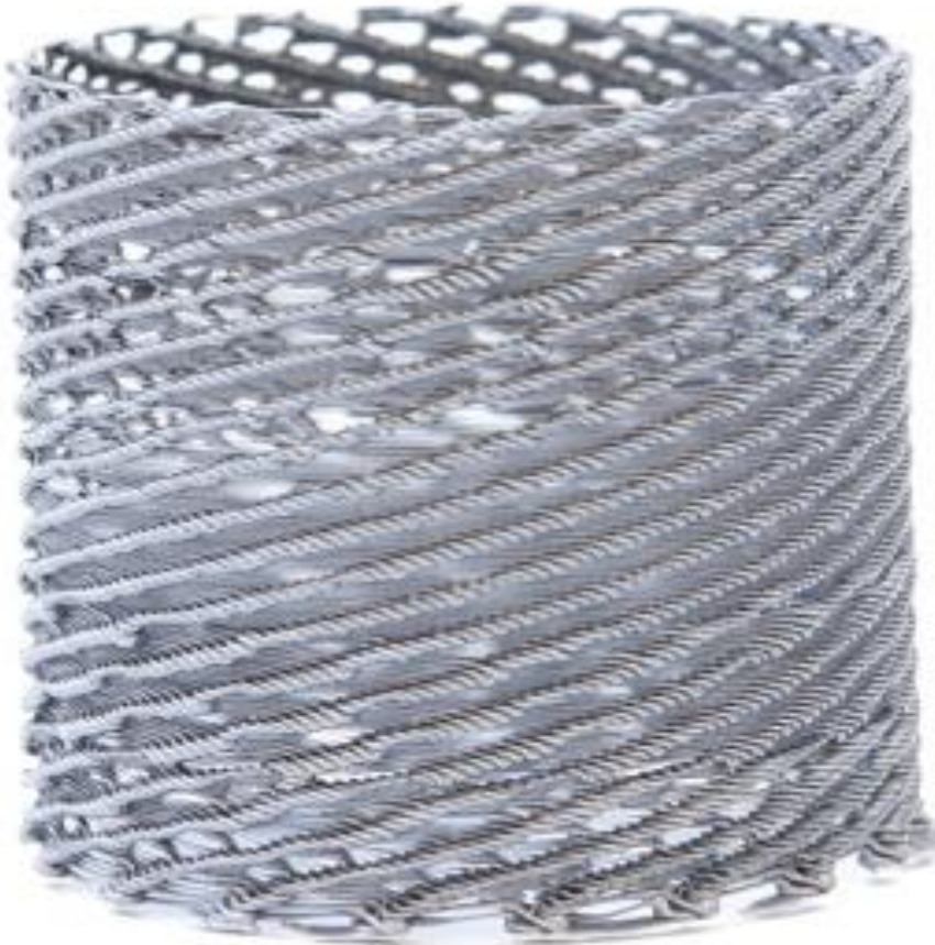
Fig. 14. 18 ribs with 240°, V_{rib} : 400 mm/min, V_{cyl} : 1600 mm/min
